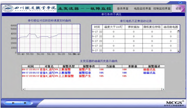
图5 MCGS系统安全及故障监控界面
